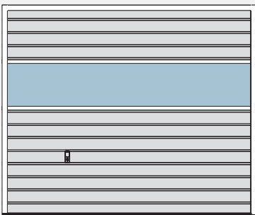
Brama z przeszkleniem VISUAL z podwójną szybą akrylową
